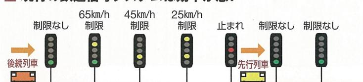
**先行列車:** ある軌道回路内の最も手前を走行しているとして後続列車の速度制限を算定 **後続列車:** 速度指示を、限られた箇所で、かつ限られた数値でしか出せない。安全のための余裕として、速度指示を引き上げるタイミングを遅らせている
